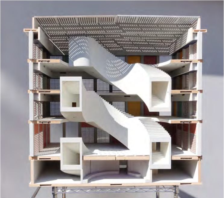
Eine Treppenskulptur ist Herzstück der Schule, sie verbindet die Notwendigkeit zweier Wege: außen ist sie Freitreppe, innen Fluchttreppe nach allen Regeln des Brandschutzes
